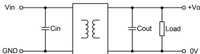
图 1 一般推荐应用电路
